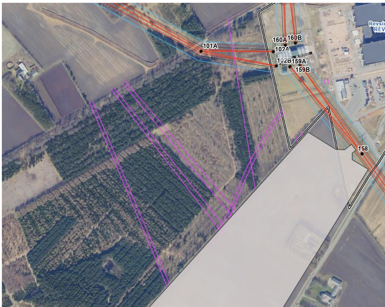
Figur 3-7. De rørlagte strækninger, lilla streg. Grå markering = nyt stationsareal.
