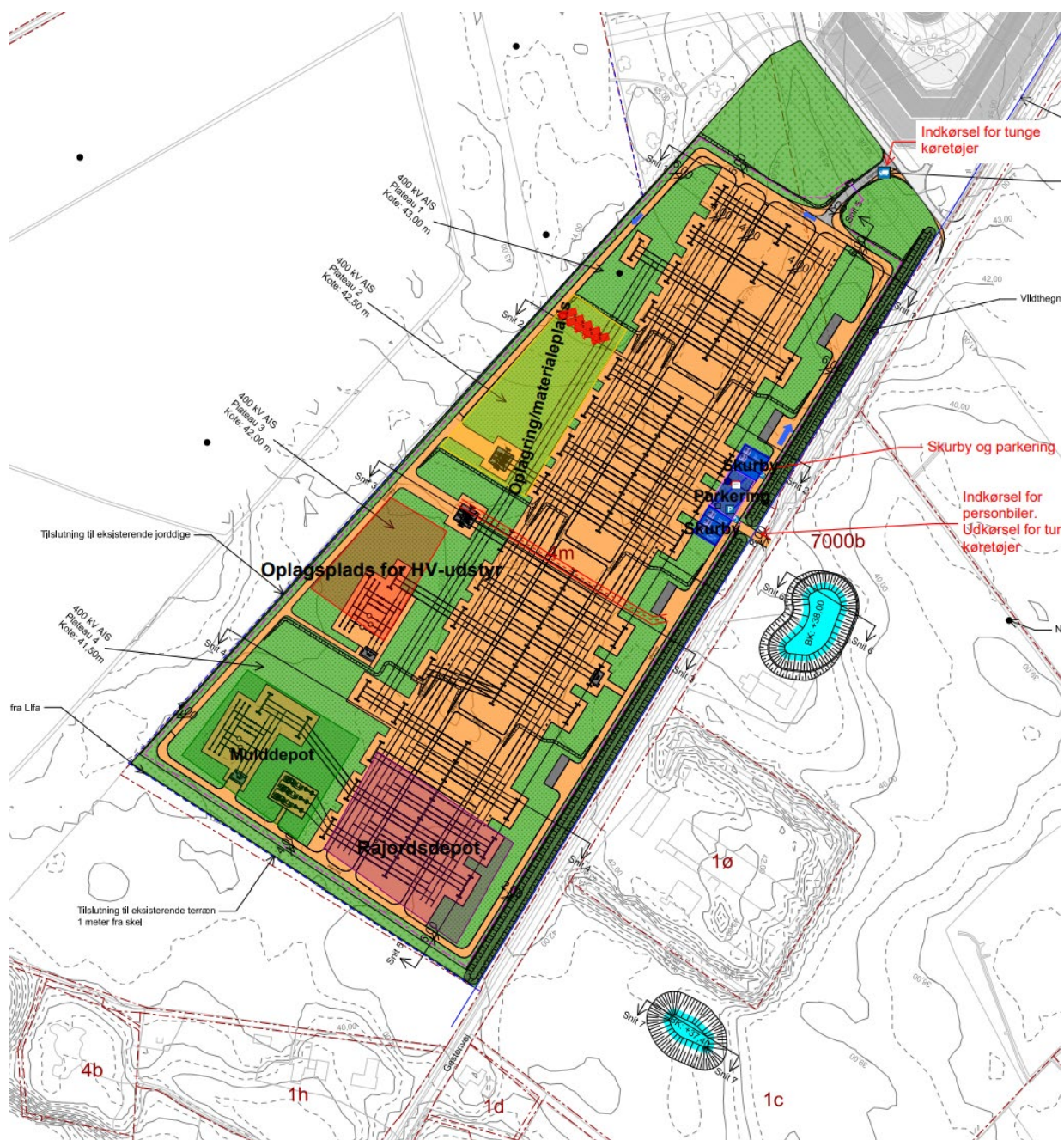
Figur 2-1. Byggepladsplan ved anlæg af Revsing Station.
